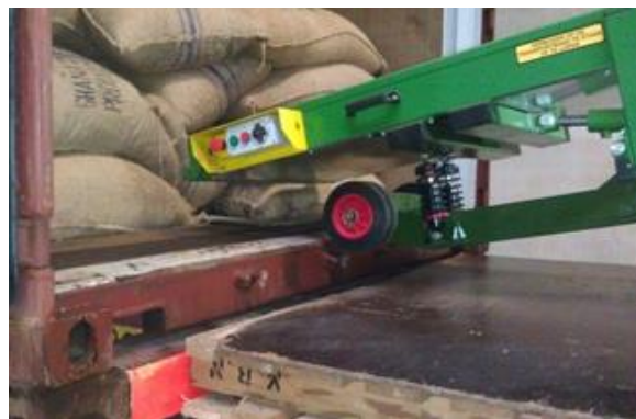
Bord arrondi sur la face avant du pewiSYS/Newland MTC™
